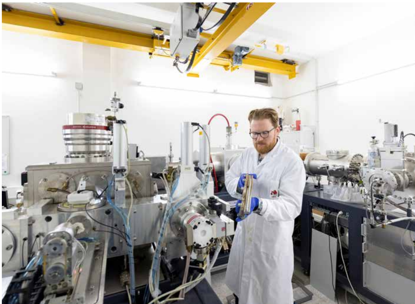
AMS-Beschleuniger im CEZA. Foto: T. Schwerdt – Curt-Engelhorn- Zentrum Archäometrie gGmbH
