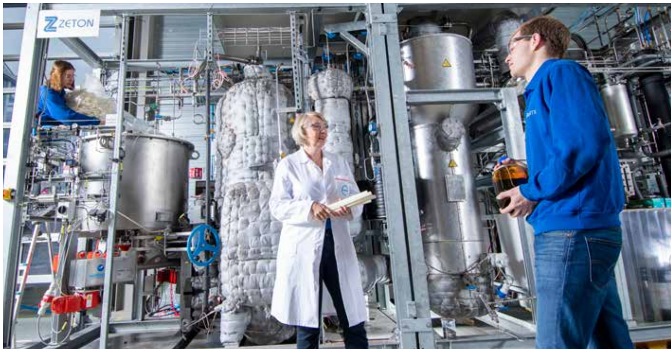
Für die Pyrolyse im Fünf-Kilogramm-pro-Stunde-Scale kommt die Pilotanlage des Projektpartners BioBTX zum Einsatz. Im Bild zu sehen (von links nach rechts): Gaby Op't Holt, Dr. Stefanie Eiden und Tijmen Vries. Foto: Covestro
