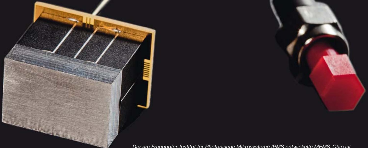
Der am Fraunhofer-Institut für Photonische Mikrosysteme IPMS entwickelte MEMS-Chip ist das Kernstück eines komplexen photonischen Mikrosystems. Foto: Fraunhofer IPMS
