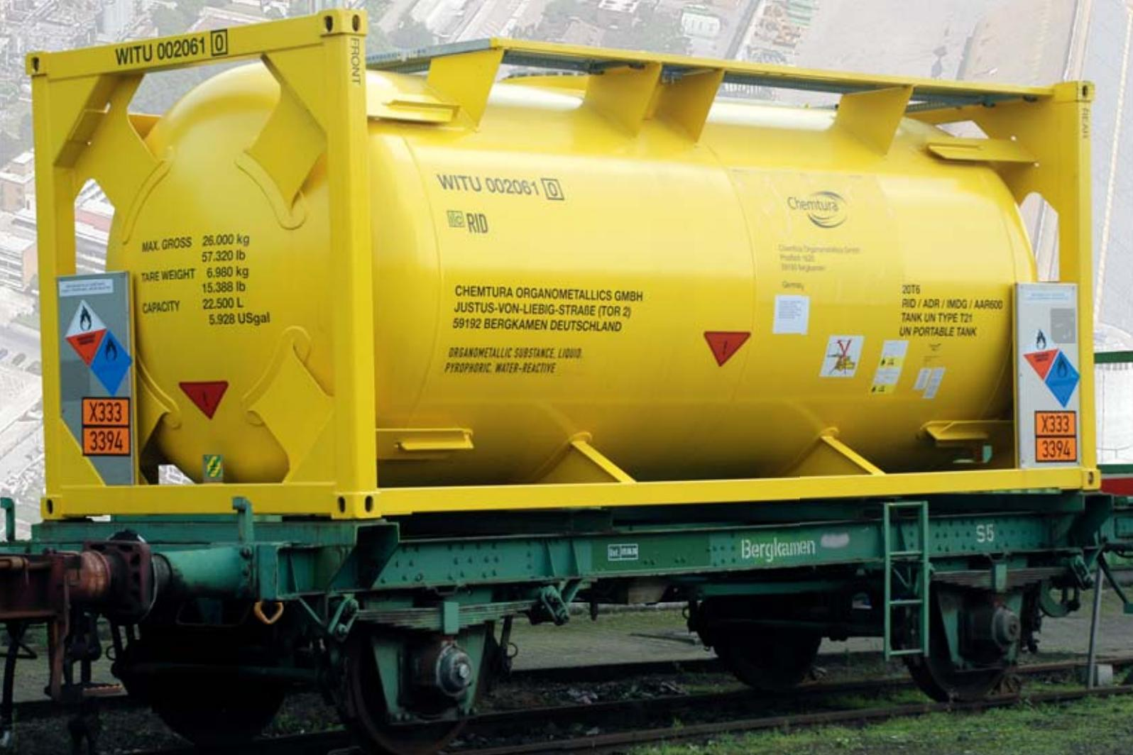
Die technisch aufwendigen Container für die weltweite sichere Auslieferung metallorganischer Spezialprodukte von Chemtura fassen bis zu 20 Tonnen. Fotos: Chemtura
