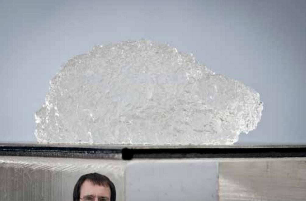
*Durch den Einsatz eines Superabsorbers kann man Polymere quellen lassen. So entsteht ein Hydrogel, aus dem entsalztes Wasser wieder herausgepresst werden kann. Foto: PKM – KIT*
