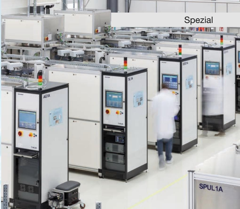
*Anders als bei chemischen Verfahren wird in der Supraleiterfertigung bei Theva Schicht um Schicht aufgebracht. Die Methode lässt sich dadurch sehr gut steuern: Fremdphasen und Defekte werden überwacht und einfach eingeschlossen, sodass die Oberfläche sauber bleibt und gute Wachstumsbedingungen bietet. Foto: Studio Tasca – Theva*
