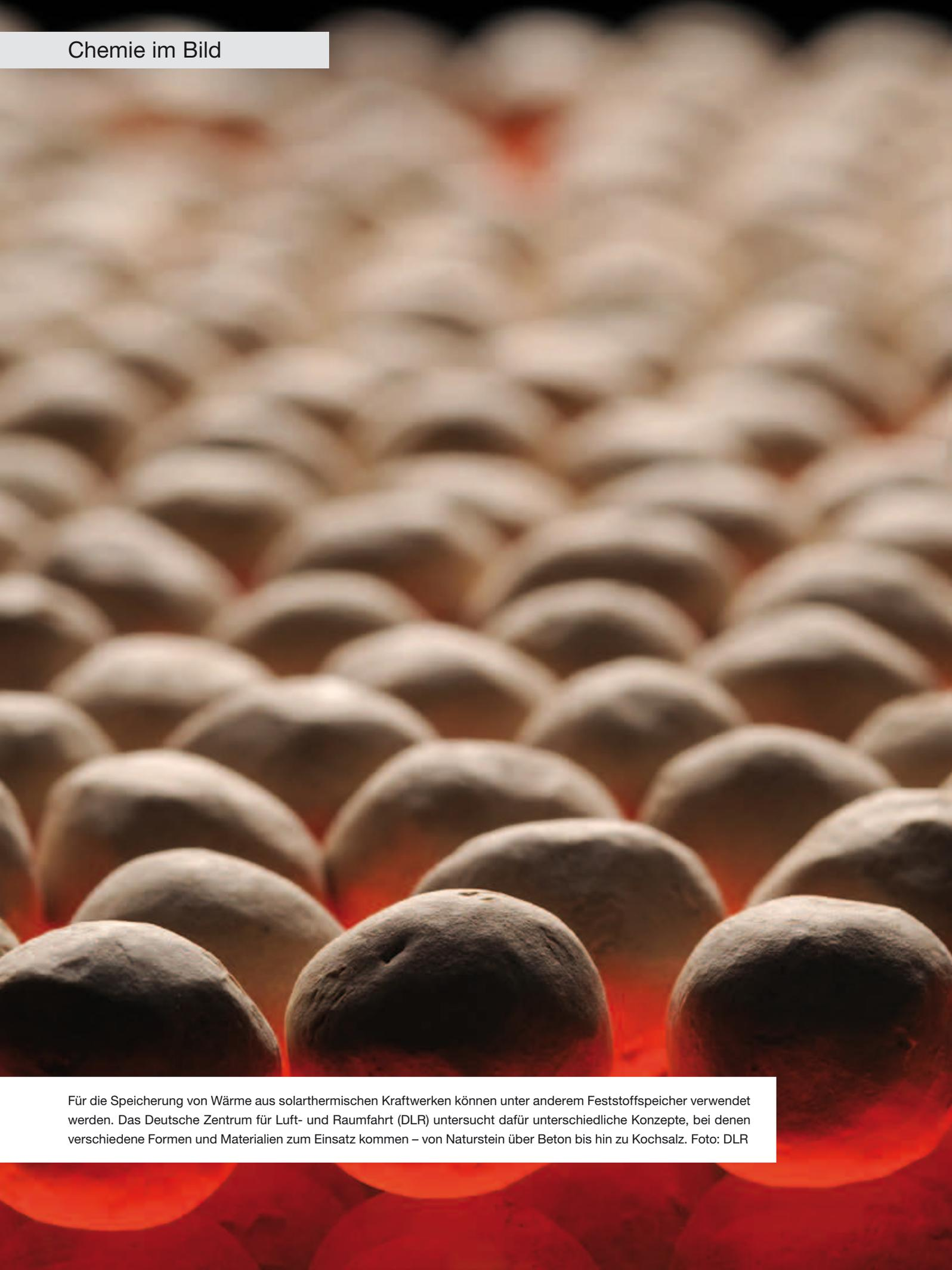
Für die Speicherung von Wärme aus solarthermischen Kraftwerken können unter anderem Feststoffspeicher verwendet werden. Das Deutsche Zentrum für Luft- und Raumfahrt (DLR) untersucht dafür unterschiedliche Konzepte, bei denen verschiedene Formen und Materialien zum Einsatz kommen – von Naturstein über Beton bis hin zu Kochsalz. Foto: DLR
