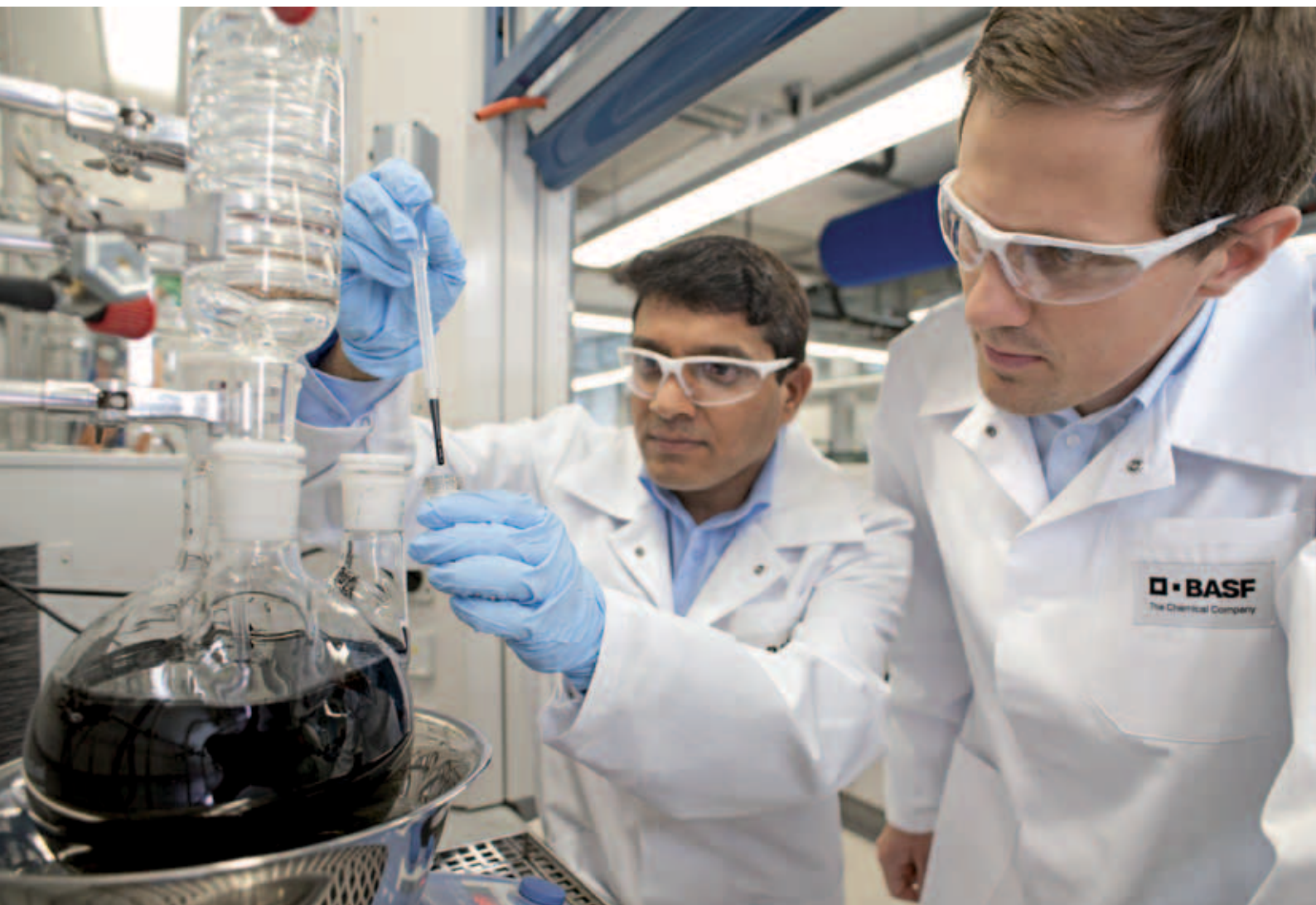
Die BASF-Chemiker Janak Kafle und Laborleiter Matthias Schwab prüfen physikalische Parameter bei der Herstellung graphenbasierter Tinten. Aus der Reaktionsapparatur nehmen die BASF-Experten eine Probe zur Viskositätsanalyse. Foto: BASF
