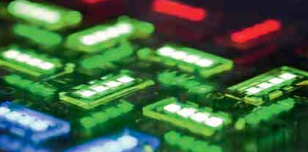
Linke Seite: Grundstoffe für die gedruckte Elektronik sind funktionelle, elektrisch leitfähige oder halbleitende Polymere. Foto: PolyIC
