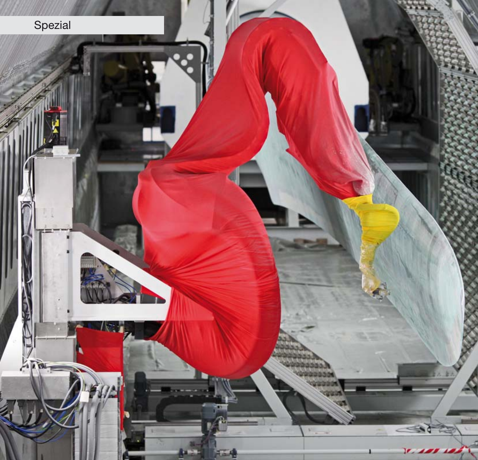
Rotorblätter von modernen Windkraftanlagen werden bei der Endfertigung verklebt. Foto: Ove Arscholl – Nordex SE
